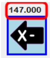
Wenn der Button inaktiv ist befindet sich die Maschine bereits an der Endlage.
