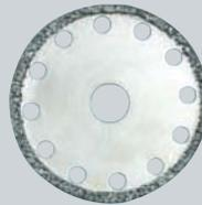
Zum Herstellen von sehr dünnen Schnitten in harten Materialien wie Glas, Porzellan und Fliesen. Durch Kühlbohrung geringe Hitzeentwicklung. Ø 50 x 0,6 mm. Mit 10 mm-Lochung.
