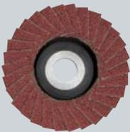
Aus Korund. Zum Schleifen und Glätten von Temperguss, Grauguss, Edelstahl, Stahl, NE-Metallen, Holz und Kunststoffen. Zum Herstellen glatter, feiner Oberflächen. Für Zwischen- und Feinschliff.
