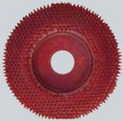
Mit Metallnadeln aus Wolfram-Karbid. Zum Modellieren von Holz, Kunststoff und Fiberglas. Ohne Kraftaufwand leicht und präzise zu führen. Ø 50 mm. Mit 10 mm-Lochung.
