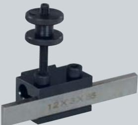
Zum PD 250/E-Schnellwechselsystem. Erlaubt das Ablängen von Werkstücken und das Einstechen von Nuten. Mit kobalthaltiger HSS-Klinge 12 x 3 x 85 mm.
